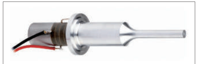
▲ 랑주뱅 트랜스듀서와 같은 파워 초음파 트랜스듀서는 산업 및 의료 분야에 사용된다. 고품질 피에조 트랜스듀서 링은 장치의 피크까지 증폭되어 대상 매체에서 진동을 유발하는 초음파를 생성한다.
